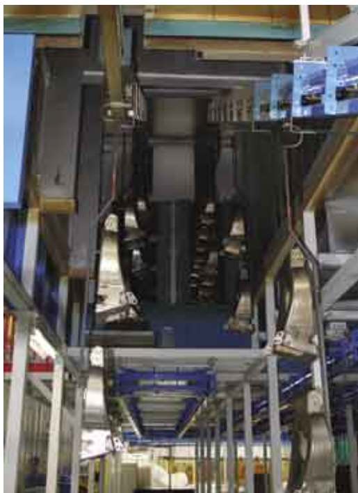
Fig. 14 - A destra, forno a campana di polimerizzazione polveri.
