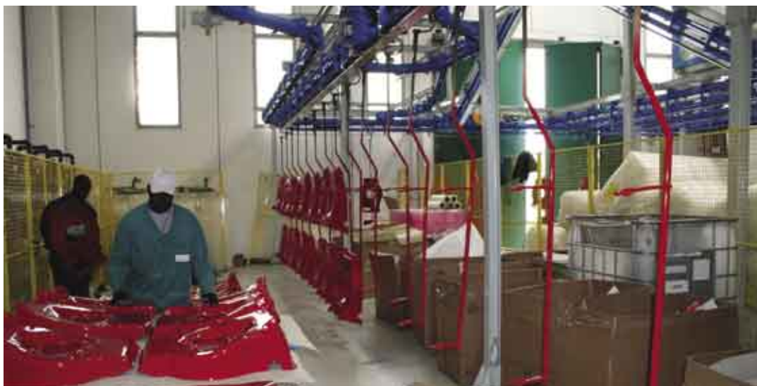
Fig. 20 - L'arrivo dei pezzi verniciati alla zona di scarico.
