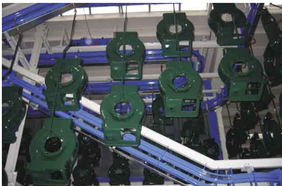
Fig. 13 - Particolare del trasportatore birotaia, con accumulo dei pezzi in altre zone.
