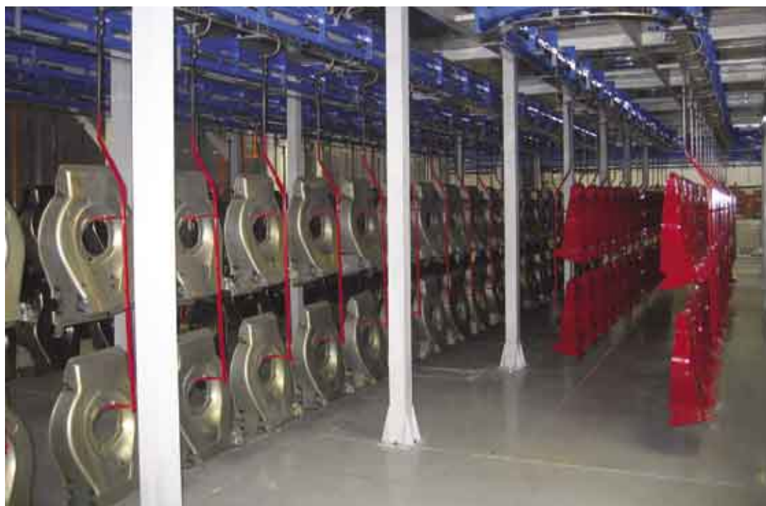
Fig. 12 - Trasportatore birotaia con accumulo pezzi nelle zone del forno e di raffreddamento.
