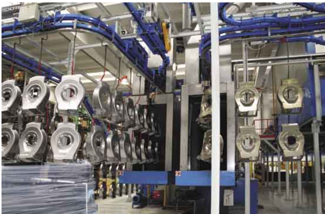
Fig. 11 - Particolare del trasportatore birotaia dei pezzi e, (in alto di figura), nel differenziatore di velocità nelle zone non soggette al ciclo operativo.
